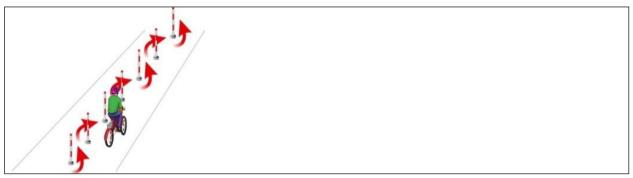
Препятствие 4 «Перестроение с одной полосы движения на другую». Длина полос составляет 3 м, ширина — 60 см. Начало и конец полос для движения обозначаются конусами. Стойка высотой до 1,8 м с перекидными картинками «Транспортные средства» формата А4 находится в начале препятствия слева по ходу движения. Общая длина препятствия не менее 7 м, количество полос для движения — 2.
